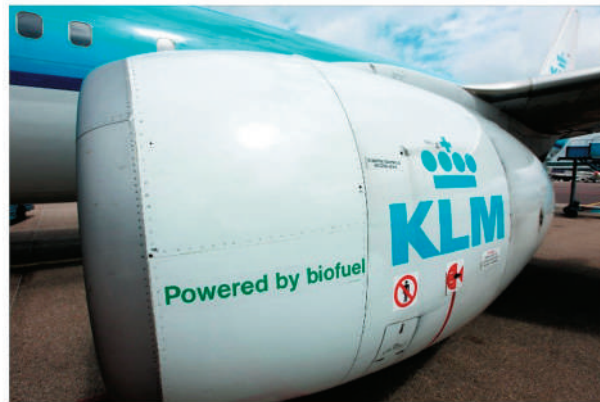
Рис. 3.5. Двигун літака компанії «KLM», що працює на суміші стандартного гасу і біопалива, дозволяє зменшити кількість викидів вуглекислого газу в атмосферу без втрати потужності і збільшення вартості перельоту
